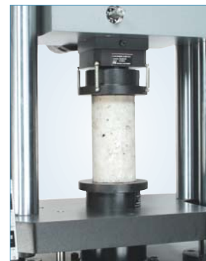
用于岩石试验的球座压缩盘
